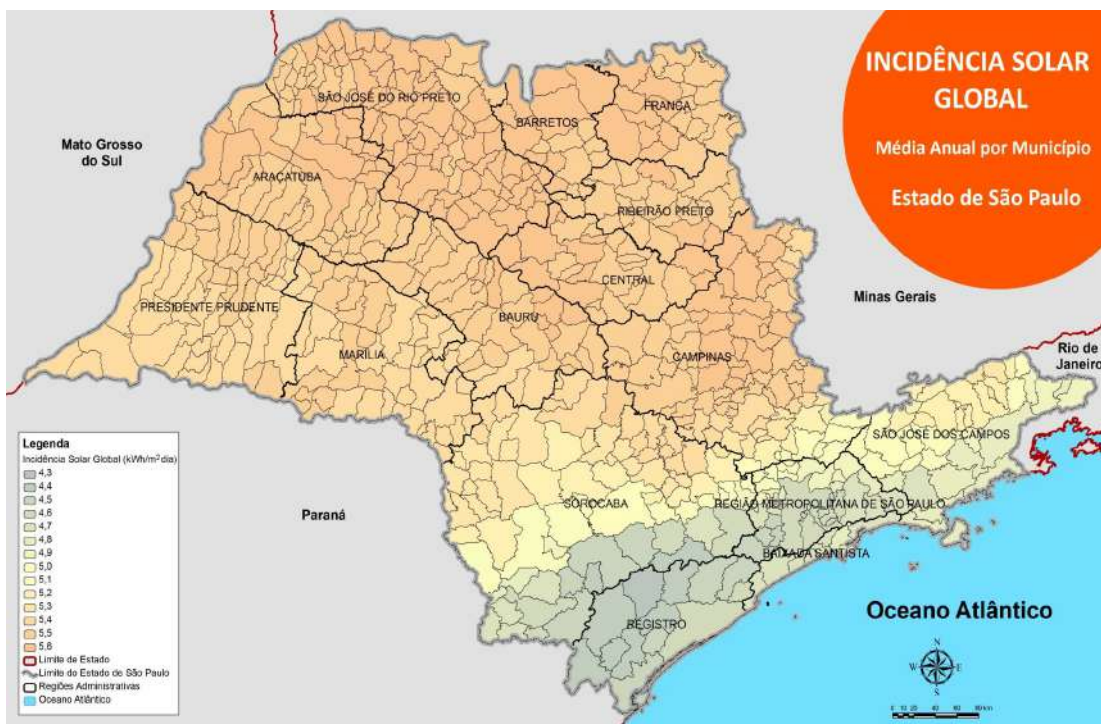
Figura 14 – Incidência Solar Global no Estado de São Paulo, média anual por município, em kWh/m 2 .dia. Fonte: São Paulo (2013, p. 23).
