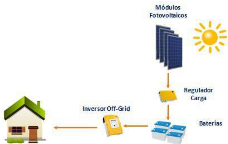
Figura 4 – Esquema de funcionamento de um sistema fotovoltaico isolado ( off-grid ). Fonte: Elergone Energias.
